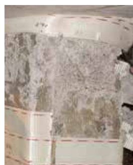
鉄筋コンクリート柱は、4波目で潰れました(左)。7波加振後にSRFの高弾性材を剥がして柱内部を確認。ほとんど損傷がありませんでした(右)。
